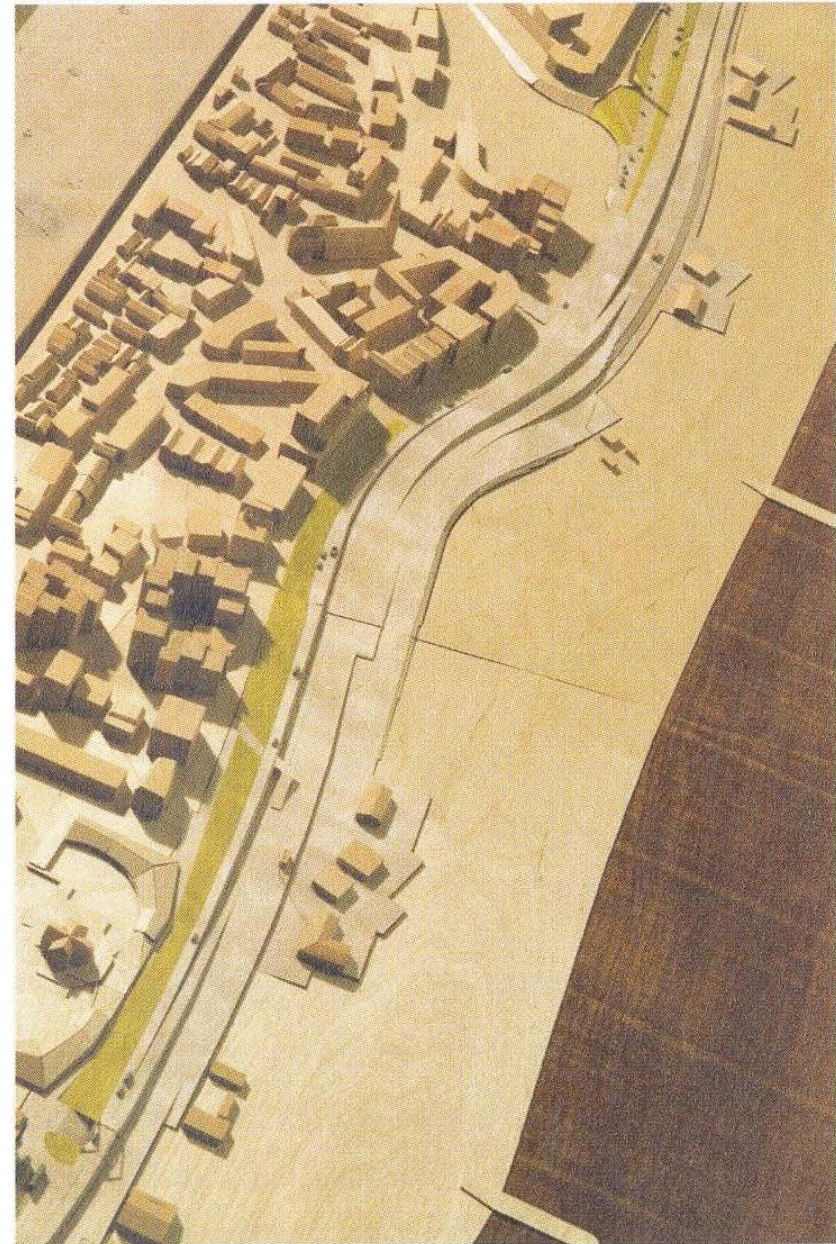
Volgens het ontwerp is de boulevard niet langer een rechte streep tussen kust en zee, maar volgt het de historische en kromme kustlijn.
