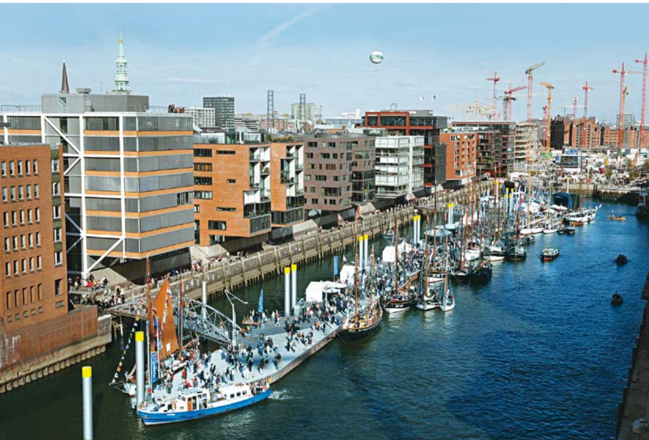
Slika 12: Plavajoči pontonski sistem, ki se dviga in spušča s plimo in oseko, za privez dvajsetih zgodovinskih ladij (ELBE&FLUT; vir: HafenCity Hamburg GmbH).
